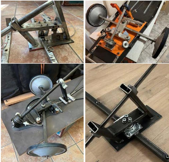
Die Seifenkiste muss mit Lenkrad, Lenksäule und Drahtseil über die Vorderachse gelenkt werden. Es dürfen nur Drahtseile von mindestens  $\varnothing 2,5\text{mm}$  verwendet werden. Der Verwendung von anderen Seilarten (zB Nylon, Perlon, Textilbändern, Ketten) ist verboten.
